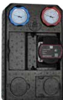
Art. E.621.03 - Unidad de distribución reversible/módulo de refuerzo DN25, compuesta por dos válvulas de bola con termómetro y válvula unidireccional, una válvula de bola para la posible sustitución del circulador, un espaciador de alineación de acero inoxidable y una carcasa aislante.
