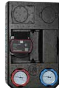
Art. E.627 - Unidad/módulo termostático reversible anticondensación DN25 para generadores de calor de combustible sólido, compuesto por dos válvulas de bola con termómetros y una válvula unidireccional, una válvula de bypass termostática de tres vías, un espaciador de alineación de acero inoxidable y una carcasa aislante.
