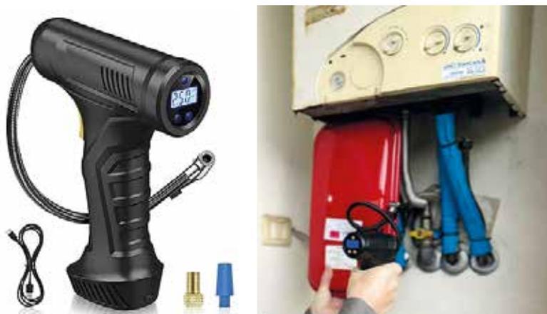
Art. F.718.20 - Compresor de aire portátil con pantalla digital para recargar depósitos de expansión y otros usos, con preajuste de presión. Funciona con batería mediante cable USB recargable incluido. - Presión máxima: 8 bar.
