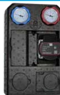
Art. E.623.03 - Unidad de distribución/módulo de presión DN25 reversible para la reducción y regulación termostática de la temperatura de punto fijo: 25 °C - 55 °C. Compuesta por dos válvulas de bola con termómetro y válvula unidireccional, una válvula termostática de tres vías, un espaciador de alineación de acero inoxidable y una carcasa aislante.
