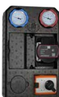
Art. E.624 - Unidad de distribución/módulo de presión DN25 reversible para bajar y regular la temperatura con motorización, compuesta por dos válvulas de bola con termómetro y válvula unidireccional, una válvula mezcladora motorizada de tres vías con bypass, un espaciador de alineación de acero inoxidable y una carcasa aislante.
