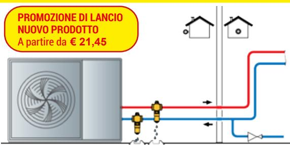
La valvola antigelo **ANTARES** permette lo scarico del fluido del circuito quando la temperatura dello stesso raggiunge un valore medio di 3°. Si impedisce così la formazione di ghiaccio nel circuito di un impianto, generalmente a pompa di calore, evitando possibili danni alla macchina ed ai componenti del circuito in caso di mancanza di alimentazione elettrica e temperatura dell'aria sottozero.
