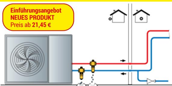
Das Frostschutzventil **ANTARES** ermöglicht die Entleerung der Flüssigkeit im Kreislauf, wenn die Temperatur im Mittel etwa 3 °C erreicht. Dadurch wird die Eisbildung im Kreislauf einer Anlage, meist einer Wärmepumpe, verhindert, um mögliche Schäden an der Maschine und den Komponenten des Kreislaufs bei Stromausfall und Temperaturen unter dem Gefrierpunkt zu vermeiden.
