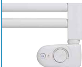
Art. T.501 - Termostato de ambiente "Thesis Plus" electrónico analógico para el control de toalleros eléctricos, montable en la resistencia eléctrica. Mediante un sensor externo, mantiene la temperatura ambiente deseada. Dispone de la función "Boost", que activa la resistencia eléctrica a máxima potencia durante dos horas. Además, incluye las funciones: "Comfort", "Stand-by" y "Timer", donde la función "Boost" se repite 1 o 2 veces al día, según la hora programada por el usuario.
