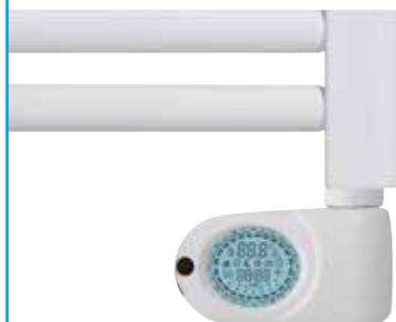
Art. T.502 – Digitales Raumthermostat „Musa Plus“, für die Steuerung von elektrischen Handtuchheizkörpern; montierbar auf dem elektrischen Heizwiderstand, mit großem, hintergrundbeleuchtetem Display. Über einen externen Sensor wird die gewünschte und vom Benutzer programmierte Raumtemperatur gehalten. Es verfügt über die Funktionen: „Komfort“, „Nachtabsenkung“, „Frostschutz“, „Timer“ und „Stand-by“.
