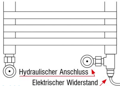
Art. G.686 – Komplettsatz zur elektrischen Ausstattung von Handtuchheizkörpern. Enthält einen Anschluss mit 1/2"IG-Ausgang und einem elektrischen Heizwiderstand, einschließlich Stromkabel (Art. G.680) – Spannung 230 V – Schutzart IP 44.
