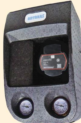
**Art. E.628 - Antikondensationsmodul für Wärmeerzeuger auf Festbrennstoffzufuhr mit motorisiertem Mischventil, hocheffizient einstellbare Umwälzpumpe "Modulex Hybrid" 6 m. Prävalenz, selbststellend, 2 Kugelhähne mit Thermometer, Rückschlagventil, Ausrichtidistanz und Isoliergehäuse.**
