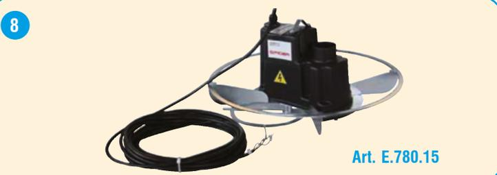
**Art. E.780.15 - Vertikaler motorisierter Abzug "TALPA" geeignet für die Entnahme von Kraftstoff von der Oberseite einer Flachbodenablagerungen auch aus großen vorgefertigten Ablagerungen, geeignet für Extraktionsanlagen mit einem Rohrdurchmesser 50, Der Abzug ist mit einem Elektromotor mit Bewegungspropellern ausgestattet, um den Zugriff auf die Kraftstoffmasse zu erleichtern.**
