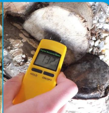
Art. F.790.00 - Digitalgerät mit großer LCD-Anzeige für die Klassen der Feuchtigkeit des grünen Brennstoff zur Verbrennung (Holz, Splitt, und Pellet) und in dem Prozess der Umwandlung der Masse in Pellets vor der Verbrennung zu messen..
